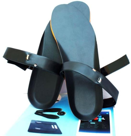
図 1: インソール型圧力センサ
